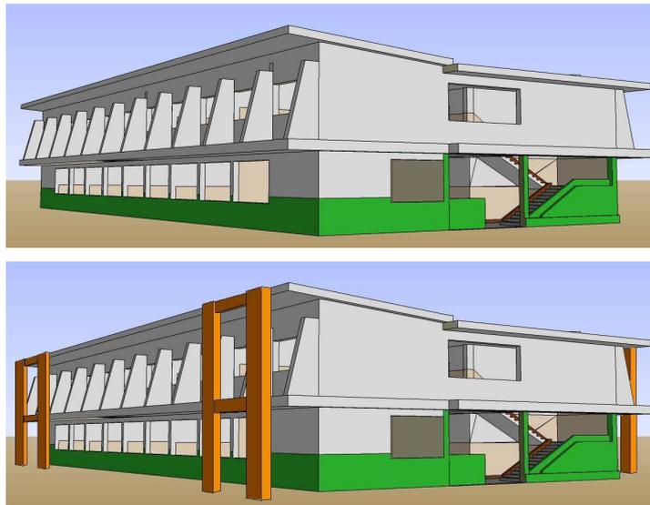
*Figura 08. Sistema estructural adicional de muros de concreto armado.*
